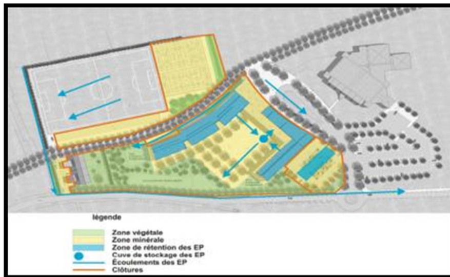
Figure 44 : Récupération des eaux pluviales
