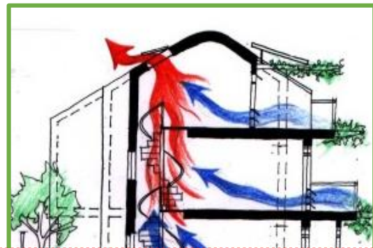
Fig.V.20: principe de ventilation naturelle
