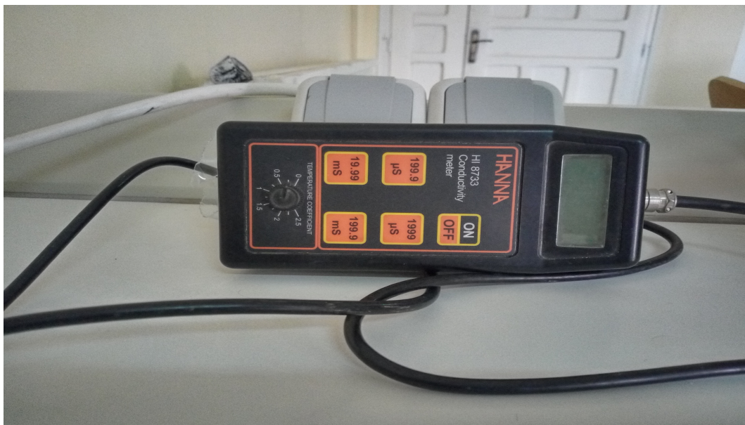
Figure. 3.7: Type de conductivity meter utilisé pour mesurer la conductivité .
