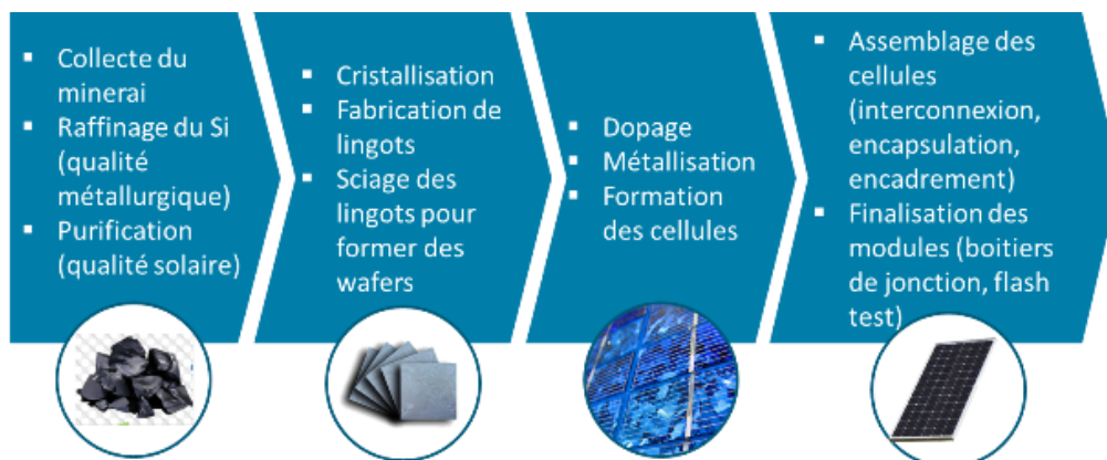
Figure I.6: Les étapes les plus importantes de la fabrication de la cellule PV
