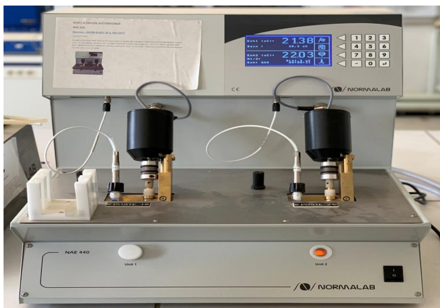
Figure I.5 : Appareil de mesure du point d'aniline (NAE 440).
