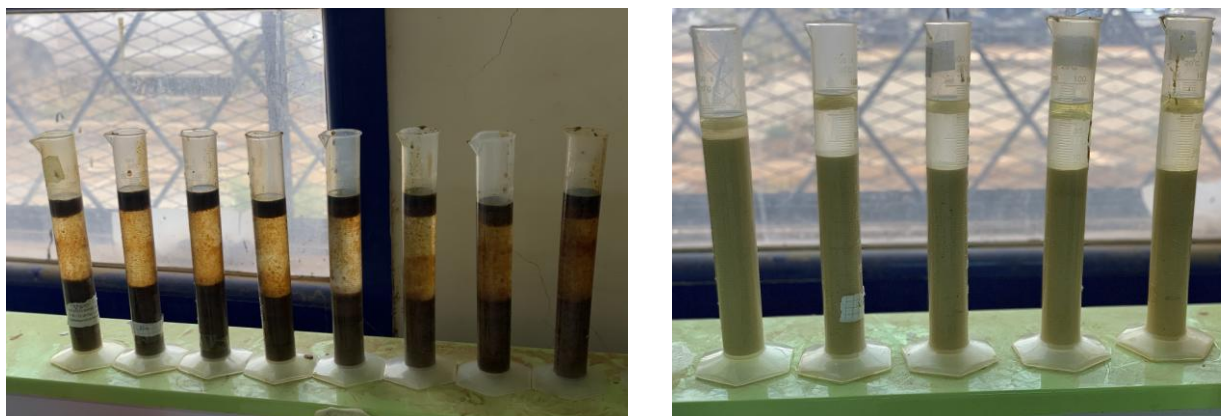
Figure I.8 : La récupération d'hydrocarbure après le protocole de lavage des sols.
