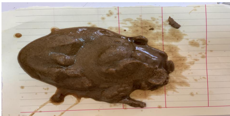
Figure I.8 : La récupération d'hydrocarbure après le protocole de lavage des sols.
