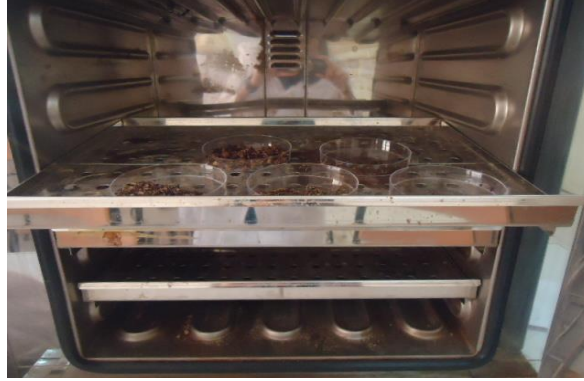
Figure 09. Stérilisation des échantillons en étuve (Originale, 2015).
