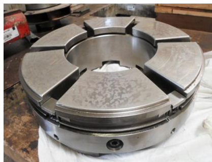
Figure 4.05. Butée axiale 6 patins oscillants du compresseur Cooper-Bessemer.
