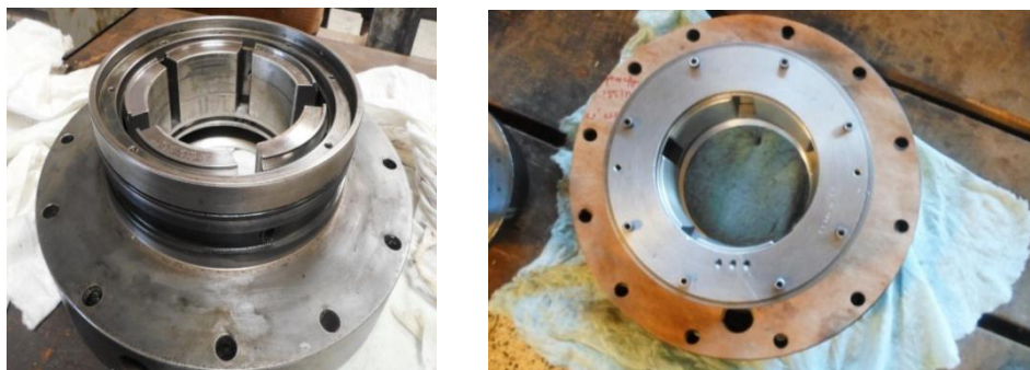
Figure 4.04. Palier 5 patins oscillants du compresseur Cooper-Bessemer.
