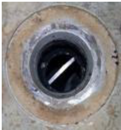
Figure 4.25. Troue d'emplacement du capteur de vitesse dans la turbine (au niveau du deuxième étage compresseur).
