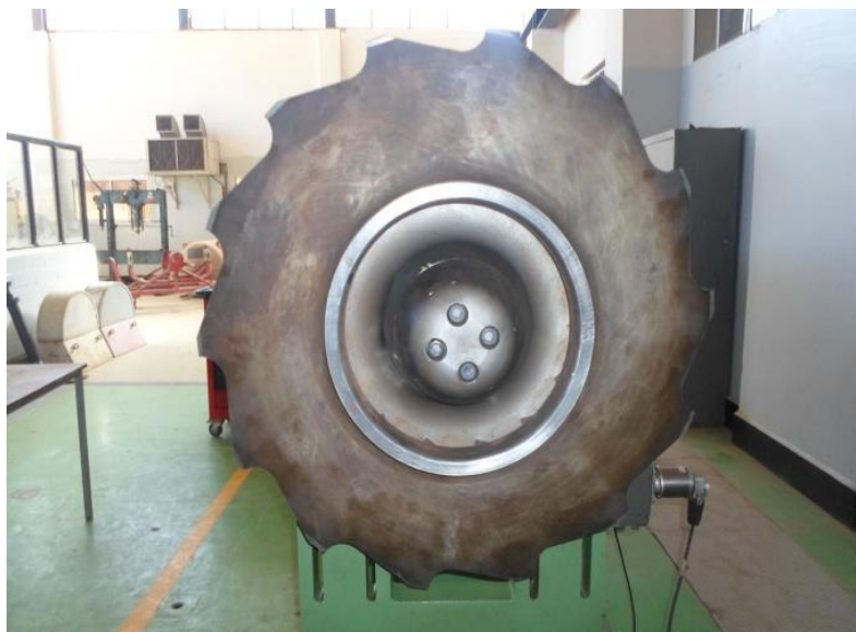
Figure 4.02. Roue 14 aubes du compresseur Cooper-Bessemer.
