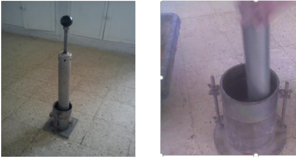
Photo II. 11: Moule Proctor Normal avec la dame dans laboratoire de Génie Civil (Laghout).
