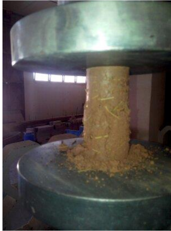
Photo IV.4 : Essai de compression simple en laboratoire de Génie Civil (Laghouat).
