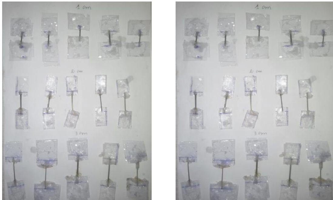
photosIII.5 : essais de traction des fibres de 1cm et 2cm et 3cm.
