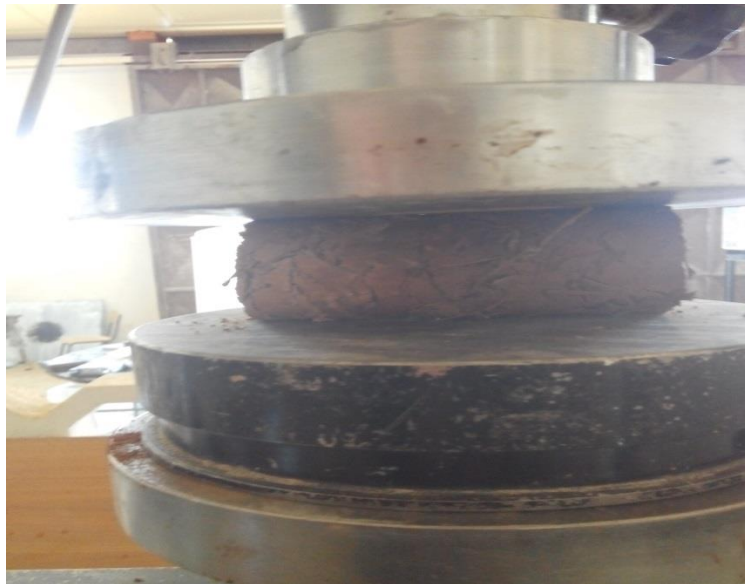
Photo IV.5 : Essai de traction simple par fendage en laboratoire de Génie Civil (Laghouat).
