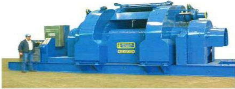
Figure 12 : le treuil de forage
