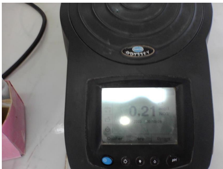
Figure 04 : Spectrophotomètre UV visible utilisé pour la détermination du taux des nitrates
