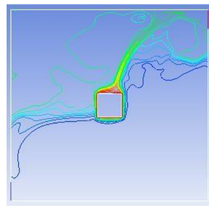
Figure IV-16: Lignes Isothermes pour différents le nombre de Reynolds et pour le cas de la source en centre ( Ra = 2.54 \times 10^7 )
