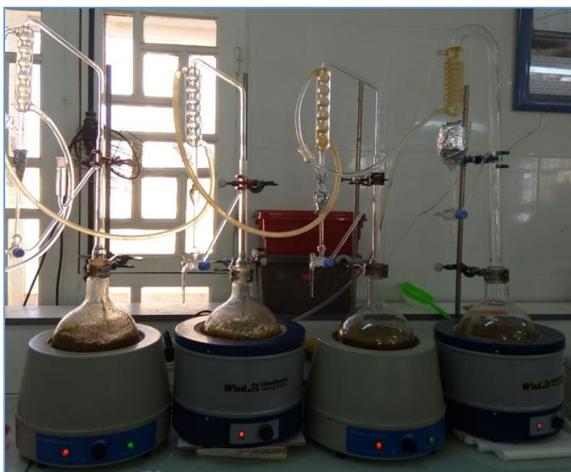
Figure 9: Montage de l'Hydrodistillation employé pour l'extraction des huiles essentielles
