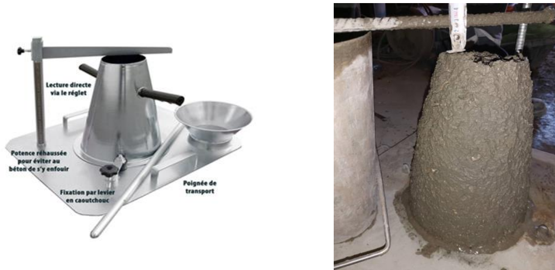
Figure 2.8. (a) cône d'Abrams, (b) mesure de l'affaissement
