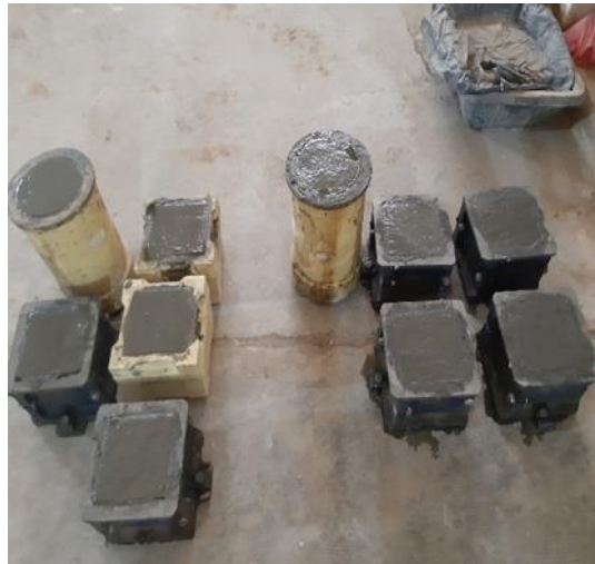
Figure 2.11. Coulage des moules
