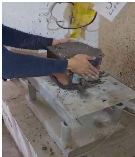
Figure 2.12. Compactage du béton
