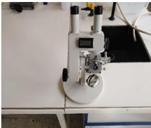
Figure 6: La détermination de la teneur en eau (indice de réfraction)
