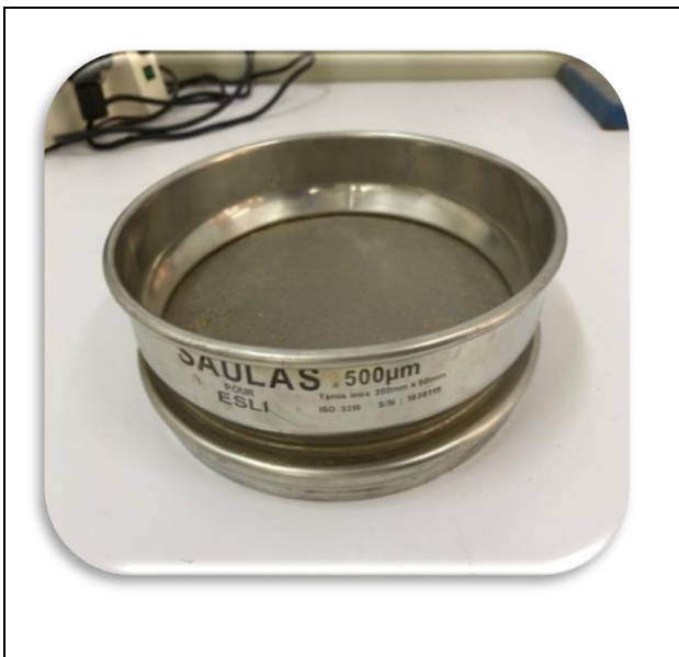
Figure 17 : Tamis de largeur (500 microns) (Cliché original, 2024).
