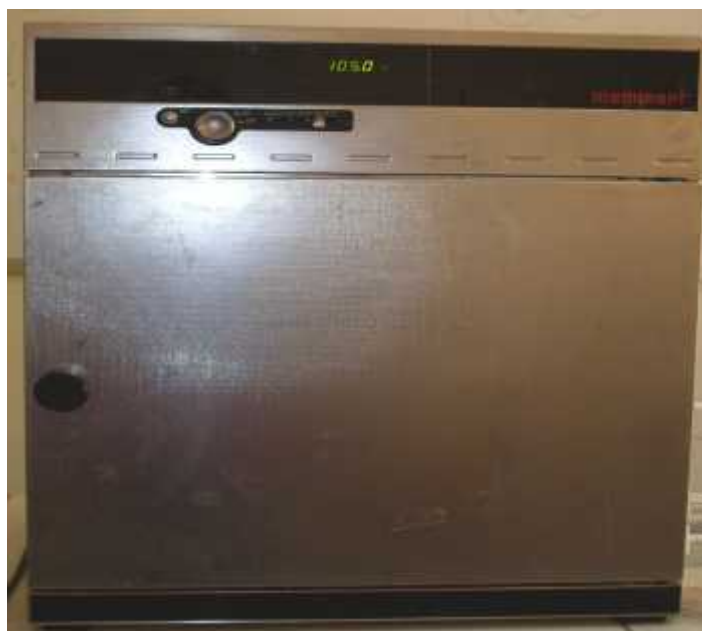
Figure 6. Détermination de l'humidité par étuve à 105°C.
