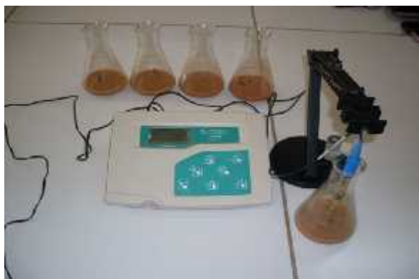
Figure 7. Mesure de pH_{eau} par pH-mètre.
