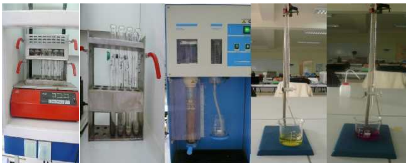
Figure 10. La détermination de la matière azotée par le dosage de l'azote totale, selon méthode de Kjeldhal.
