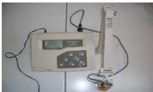
Figure 8. Mesure de conductivité électrique (CE).
