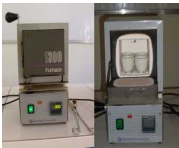
Figure 9. Détermination de la teneur en matière organique par calcination.
