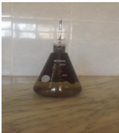
Figure II-12 : Essai masse volumique absolue par la méthode de pycnomètre.
