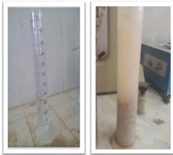
Figure II-5 : Essai masse volumique absolue par la méthode de l'éprouvette graduée.
