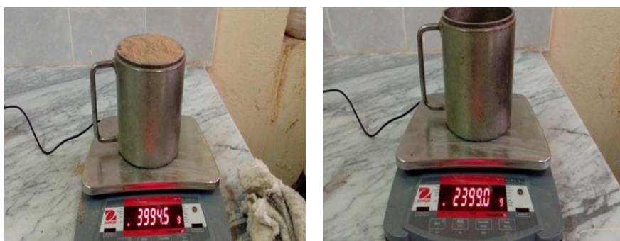
Figure II-6 : Essai masse volumique apparente par la méthode de récipient.
