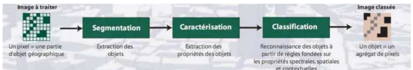
Figure II.5.Processus d'analyse orientée-objet sur des images THRS (KANA Fabrice.2011).
