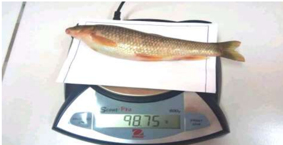
Figure 16. L'appareillage utilisé pour la pesée des espèces (Une balance de type Scoutro (OHAUS) ayant une précision de 10^{-2} g) (Originale, 2018).
