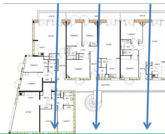
Figure 08 : system de ventilation traversante source : http://lpro9.free.fr/Realisation%20HQE.html
