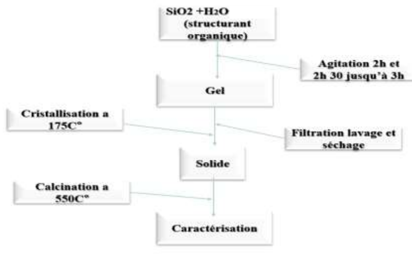
Figure 11 : Protocole expérimental de la synthèse hydrothermale pour l'obtention de Silicalite-1
