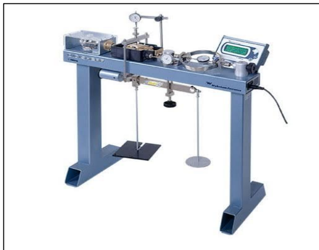
Figure II-11: Appareil de cisaillement [17]
