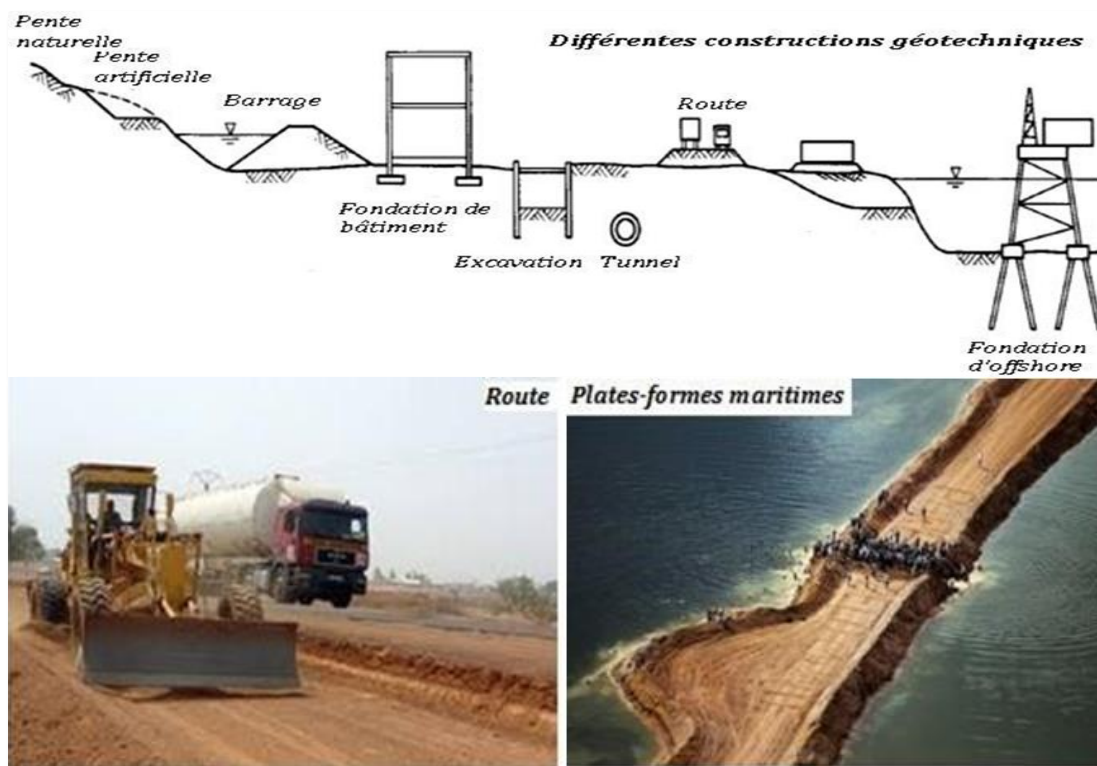
Figure I-1: Exemple -1- des constructions géotechniques. [2]
