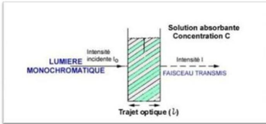
Figure II.4: Représentation schématique de la cellule
