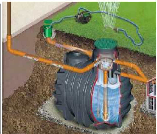
Figure V 48: réservoir d'eau d'arrosage Source: Bâtiment du futur .N°69 .Juillet 2012
