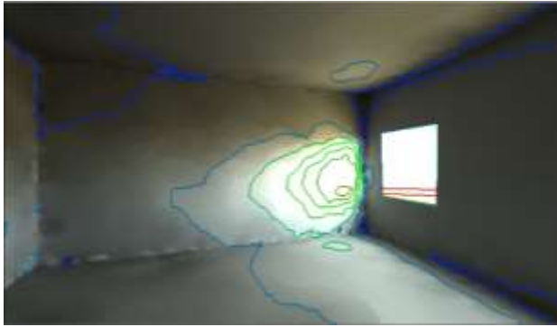
Figure IV-24 Niveau D'éclairément en Contour Ligne à 09 :00h Source : Auteur
