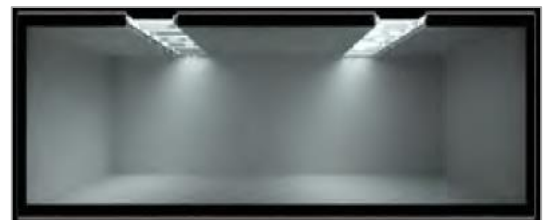
Figure 6: Eclairage zénithal de type tabatière Source : www.squ1.com
