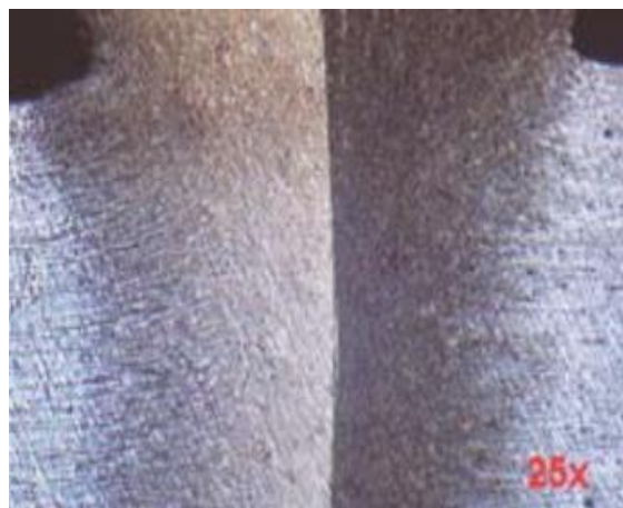
FigurI.8.5 : Interface de fusion sur un alliage d'acier faiblement allié soudé par friction linéaire sous pression montrant une zone affectée thermiquement et une déformation plastique associée. Fond clair, 25x.
