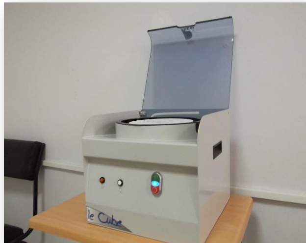
Figure II. 19 : Polisseuse (laboratoire de mécanique)
