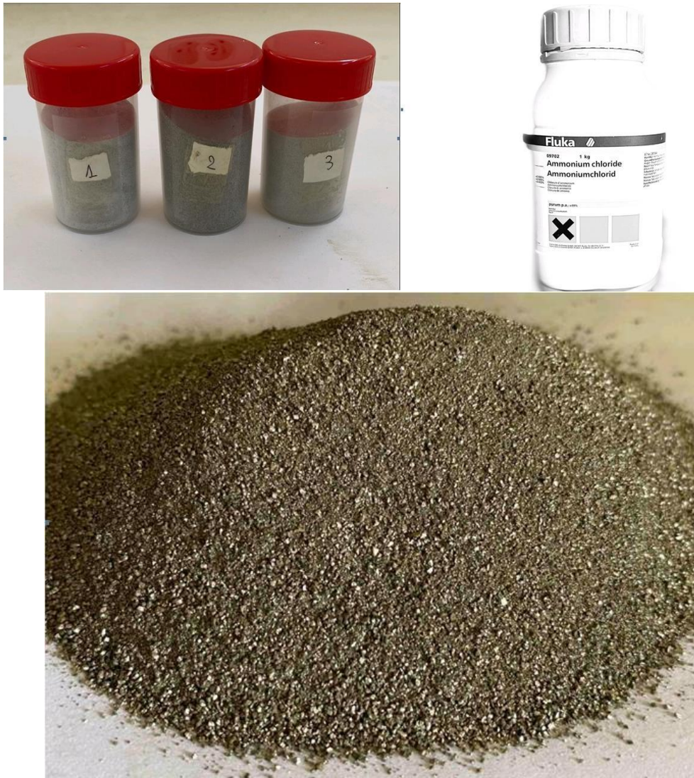
Figure II.1 : Poudres de base utilisées pour la préparation des mélanges pour le traitement TRD
