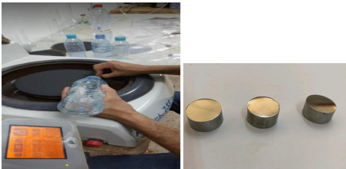
Figure II.3 : Machine de polissage et échantillons après polissage
