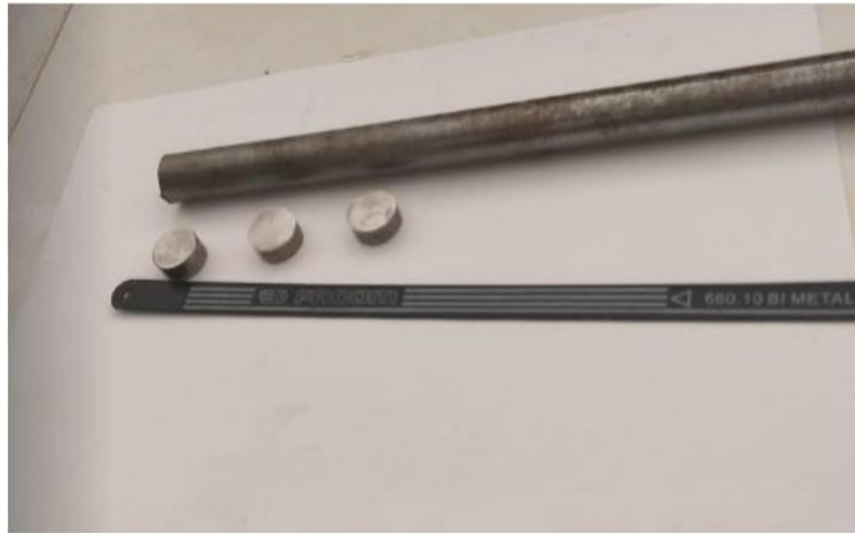
Figure II.2 : figure représente le découpage d'échantillon de métal 100Cr6
