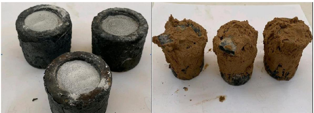
Figure II.5 : Préparation des creusets avant l'introduction dans le four
