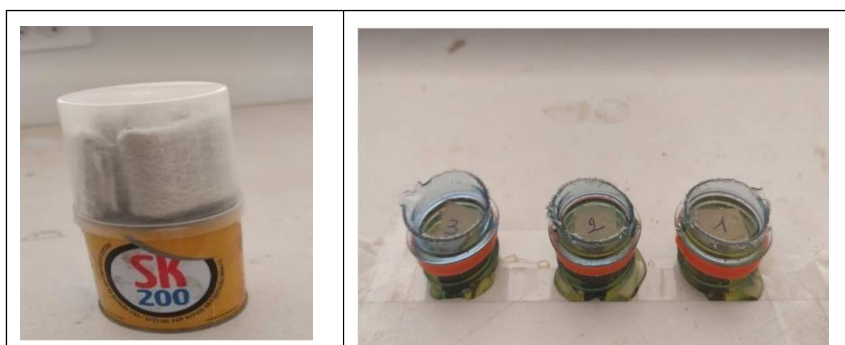
Figure II.9 : Résine Sk200 utilisée pour l'enrobage des échantillons
