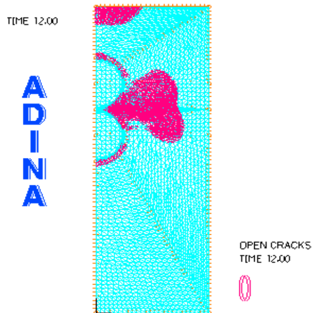
Fissuration de l'enrobage du béton ; \Delta T_{sp} = -60^\circ\text{C}
