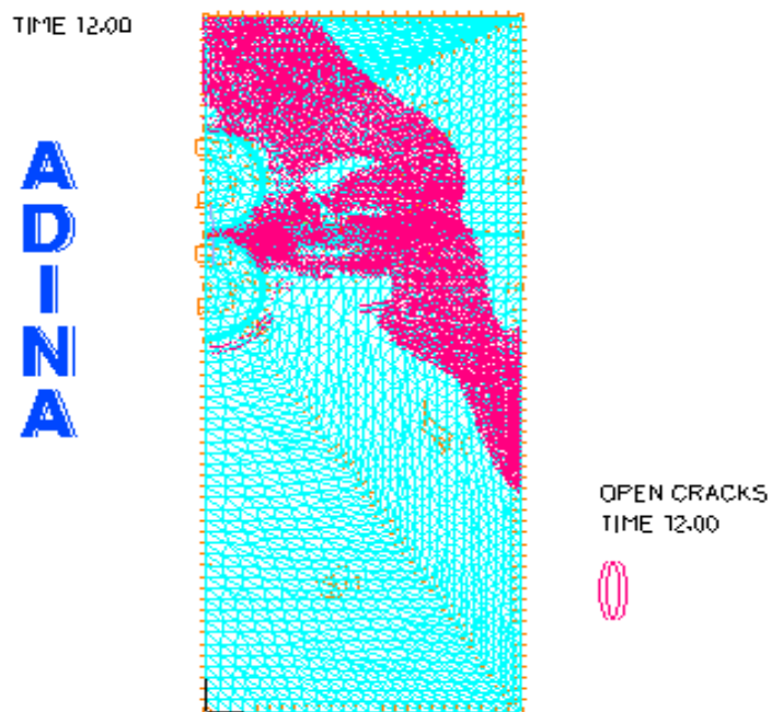
Fissuration de l'enrobage du béton ; \Delta T_{sp} = -60^\circ\text{C}
