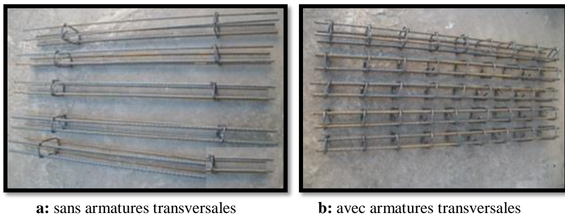
Figure III.2: Ferrailage adopté pour les poutres
