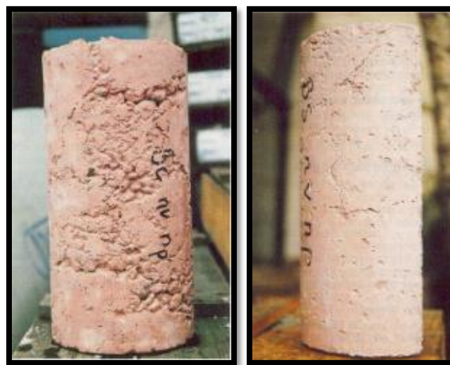
a:- Béton traditionnel b:- Béton de sable
