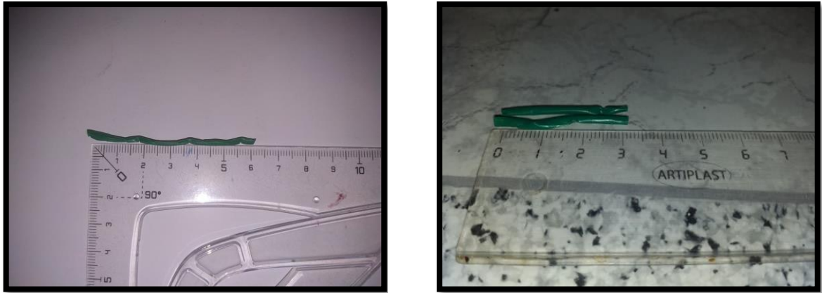
Figure II.10 : Les deux longueurs de fibres de polypropylène testées
