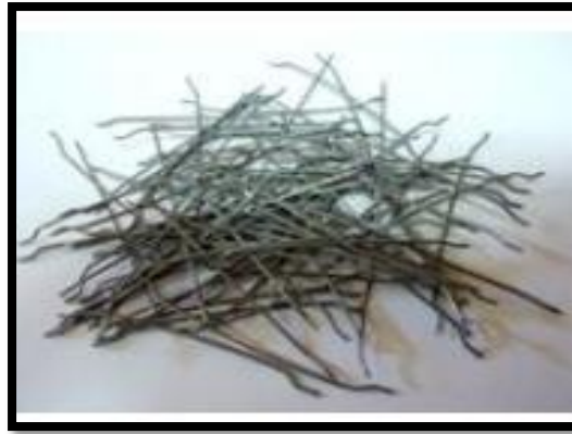
Figure I.15: Déchets d'acier (Setti et al. 2012)
