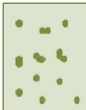
Figure I.5 : Schéma qui représente la coalescence.
