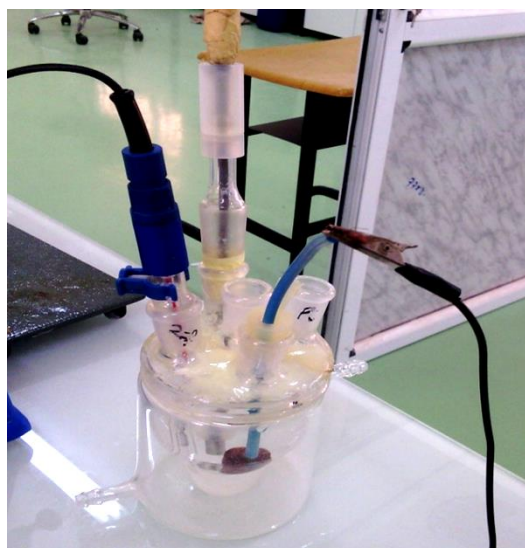
Figure III.2 : La cellule électrochimique en verre pyrex a trois électrodes
