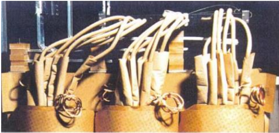
Figure. I.8. isolation solide dans les transformateurs
