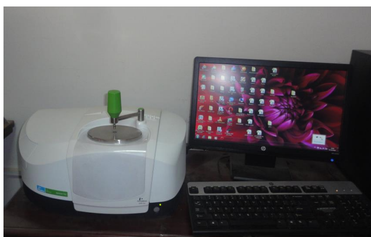
Figure. IV.16 : photographie du dispositif FTIR (Laboratoire de mécanique Laghouat)
