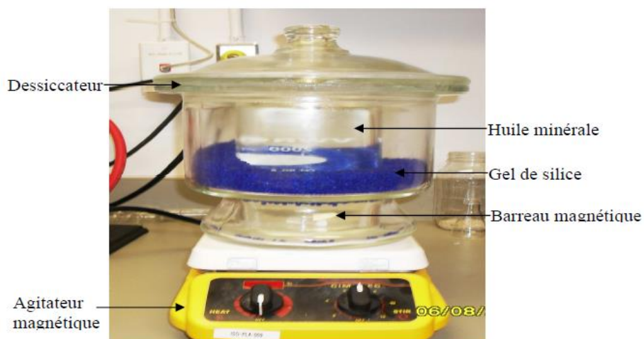
Figure. IV.10. Technique de déshumidification et dégazage de l'huile
