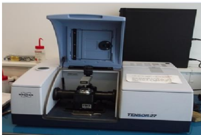
Figure. IV.15 : photographie du dispositif FTIR (Laboratoire de chimie Laghouat)
