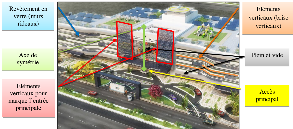
Figure 25:Façade principale de l'hôpital.
