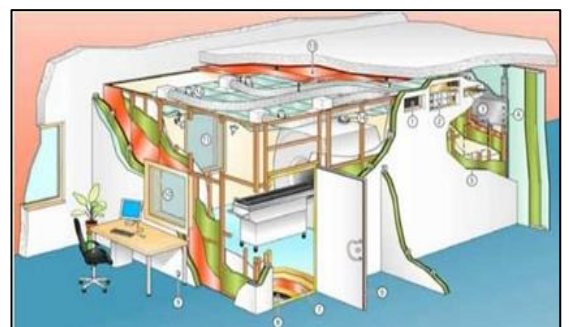
Figure 9:l'isolation des salles radiologie. Source : Documentation Philips Systèmes Médicaux.
