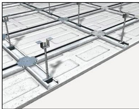
Figure 11: Fixation du faux plafond.
