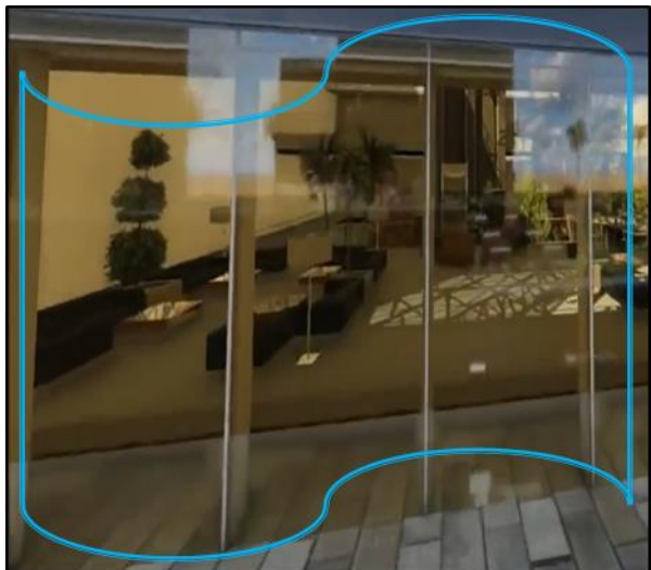
Figure 35:Mur rideau en double vitrage.
