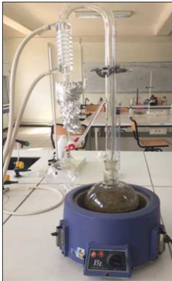
Figure16 : Montage de l'hydrodistillateur (Clevenger)
