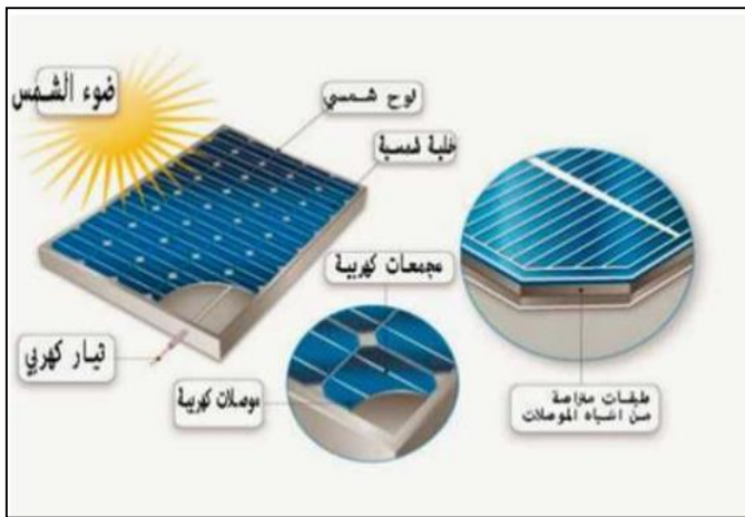
صورة 40 - توضح مكونات الخلية الشمسية المصدر : http://Www.kawngroup.com .
