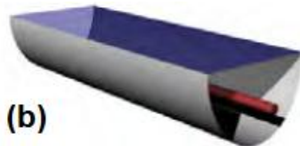
Figure 1.2 : Les réflecteurs : (a) de Fresnel, (b) cylindro-paraboliques [3].
