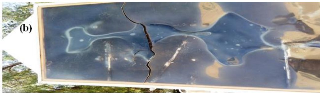
Figure 5.47 : Etat de vitre : (a) Variation de l'écart entre la température de la vitre et la température ambiante en fonction du temps pour différentes hauteurs, (b) cisaillement de la vitre.
