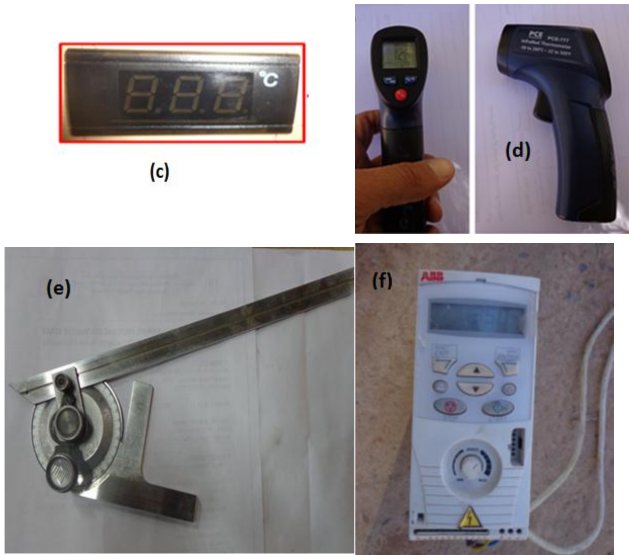
Figure 4.13 : Instrumentation et appareillage:(a) Solarimètre, (b) L'anémomètre à ailettes, (c)Thermomètre digital, (d) Thermomètre infrarouge, (e) Rapporteur d'angle et (f) Variateur de tension.
