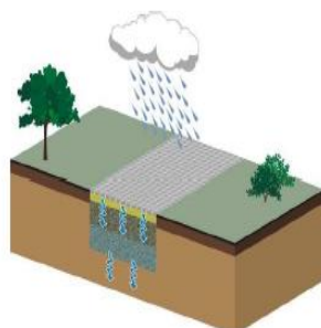
L'infiltration directe (pavés drainants)
