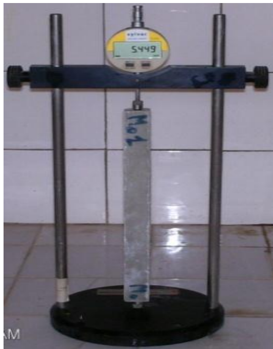
Figure II-7 : Rétractomètre muni d'un comparateur de mesure de la variation de longueur.
