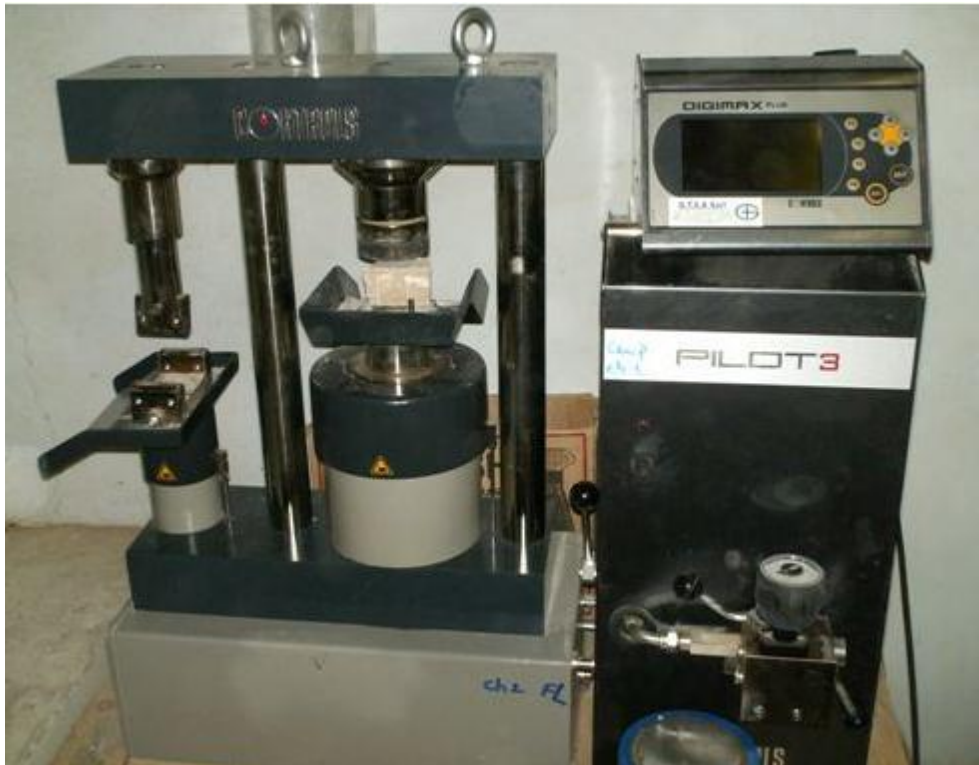
FigureII-10 : Dispositif expérimental de mesure des résistances à la traction par flexion et compression.
