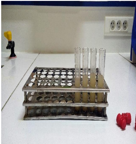
1-Verser l'échantillon dans les tubes
