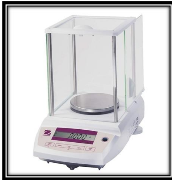
Figure III.4 : balance de marque OHAUS de précision 0.001g
