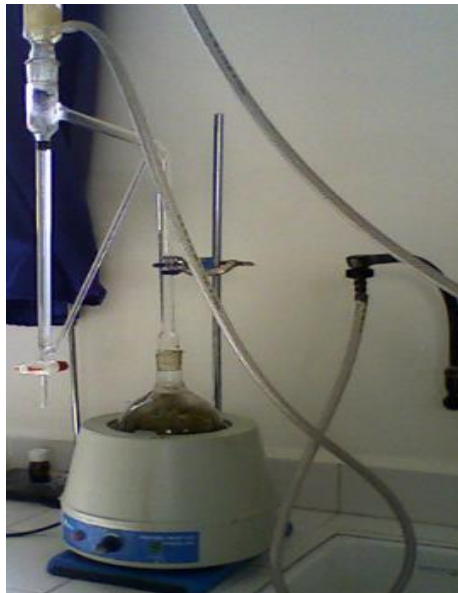
Figure 7 : Montage d'hydrodistillation (Clevenger).
