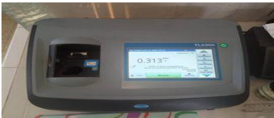
Figure 15 : Mesure de la turbidité par le turbidimètre
