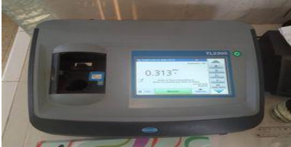
Figure 18 : Spectrophotomètre pour la détermination du nitrate et le nitrite, sulfate.
