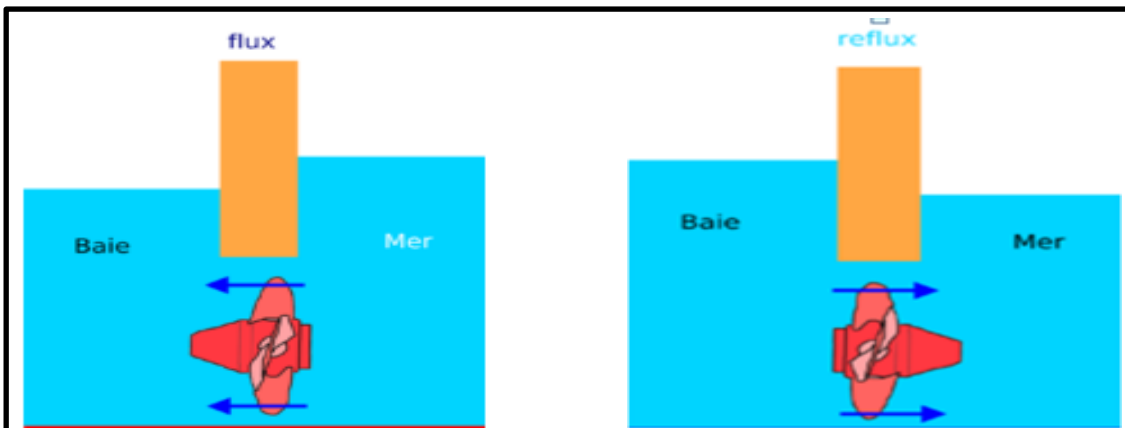
Figure n° 08: Principe d'une centrale marémotrice
