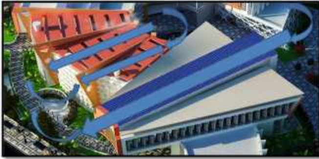
Figure 138 : Ventilation transversale [Source : Auteurs]
