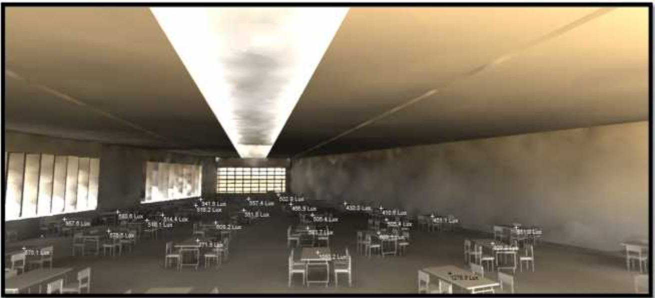
Fig182 : Mesure de niveau d'éclairément a des points diffère a ciel dégagé ; Source : auteur
