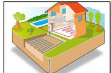
Figure74: coupe sur géothermie [Source : www.archdaily.com]
