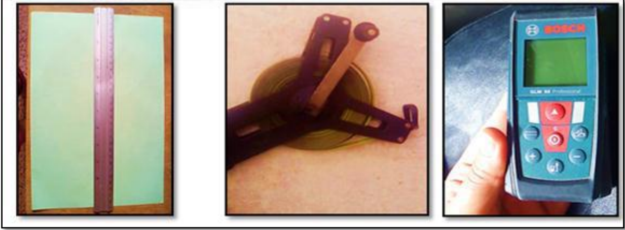
الشكل (51): الأدوات المستعملة في الرفع المعماري (الديكامتر 20م. مسطرة قياس 30سم) المصدر: اعداد الطالب
