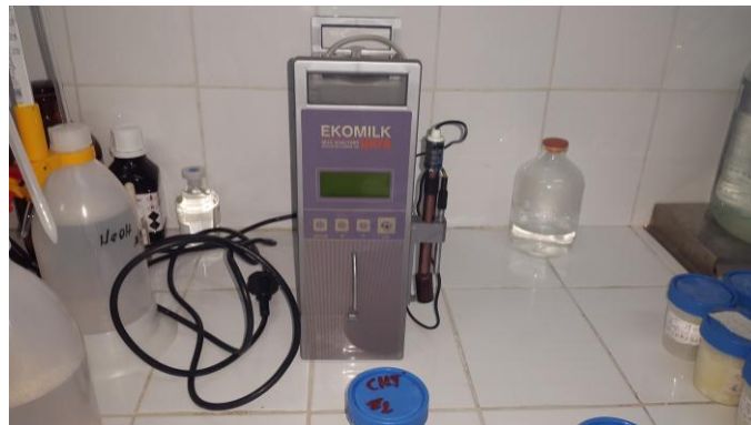
Figure N°4 : EKOMILK utilisé pour analyse physico-chimique du lait
