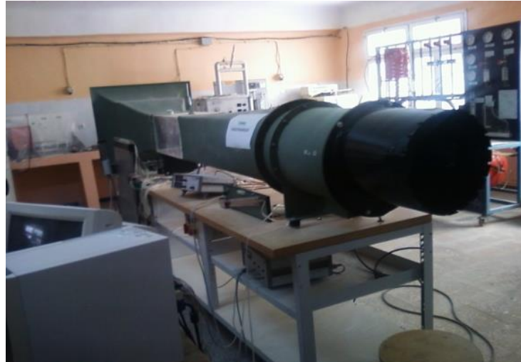
Fig. 5.23: Soufflerie subsonique HM 170 Gunt
