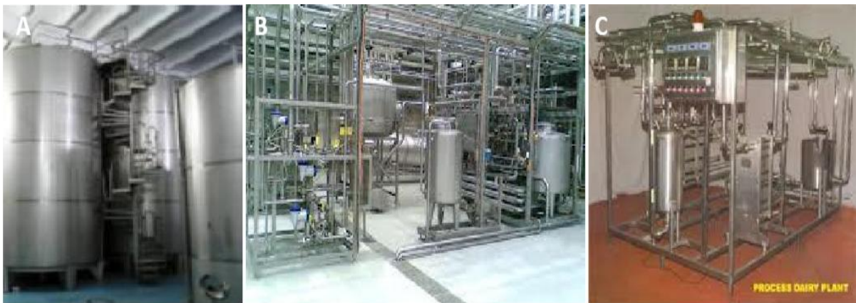
Figure 04 : Equipement laitiers. (A) : tanks de stockage du lait, (B) : système de canalisation (lactoducs), (C) : un échangeur thermique à plaque (Malek, 2013).
