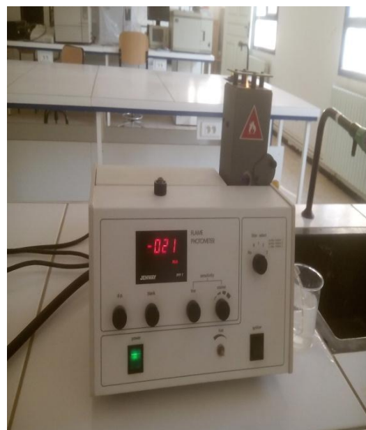
Figure 7 : spectrophotométrie de flamme (original.2017)
