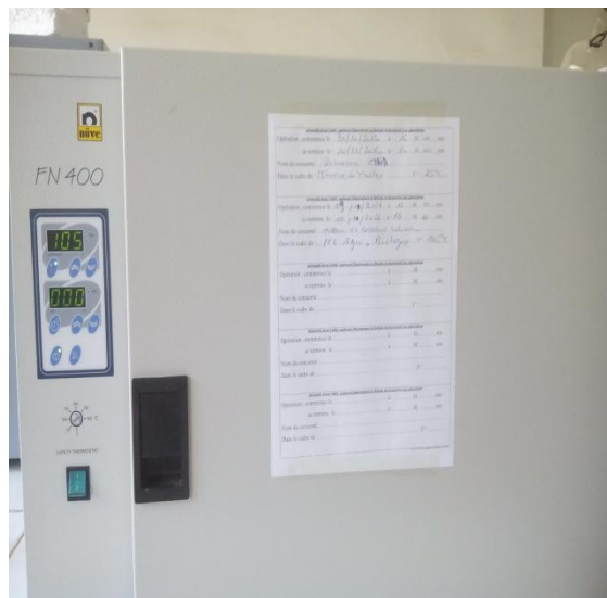
Figure 4 : Etuve à circulation d'air (original.2017)
