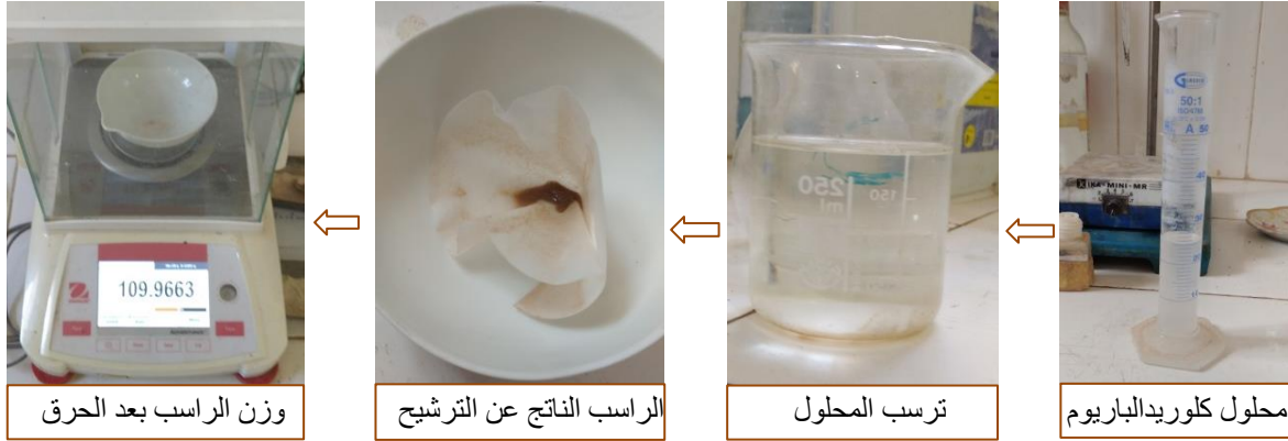
الشكل (III-46): مراحل تجربة الكشف عن نسبة السلفات (sulfate) المصدر: من تصوير الطالبة بتاريخ 2023/05/25
