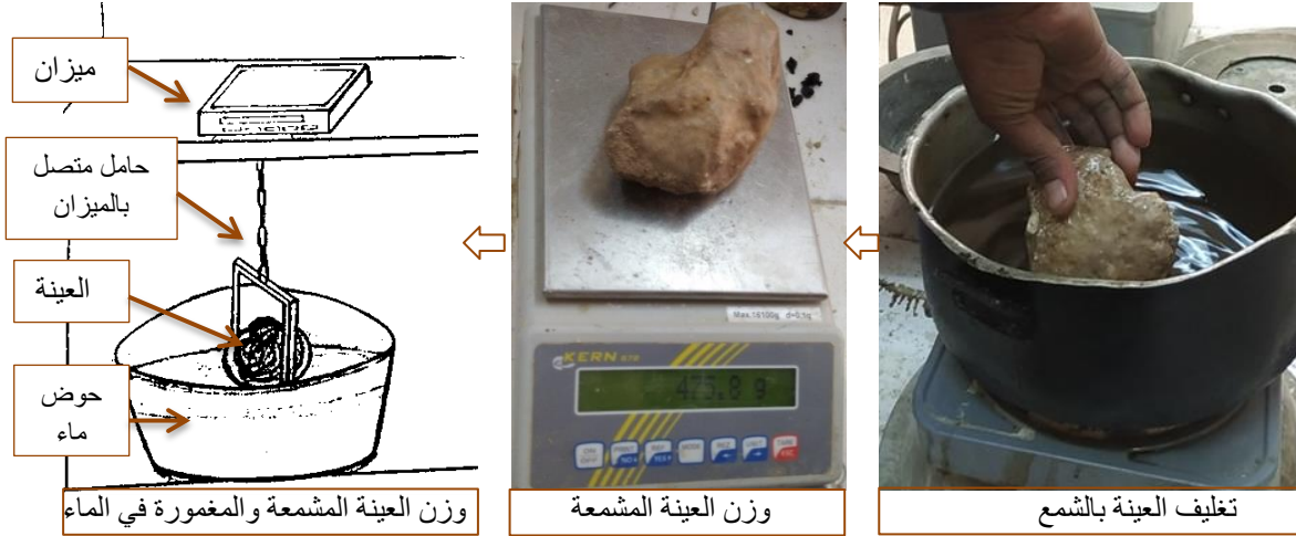
الشكل (III- 40): الخطوة الثانية في تجربة الكتلة الحجمية المصدر: من تصوير الطالبة بتاريخ 2023/05/22
